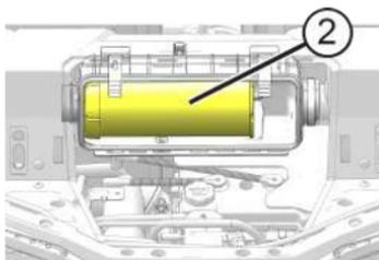
5. Para remover o filtro, deslize-o na direção do lado do passageiro do veículo.
