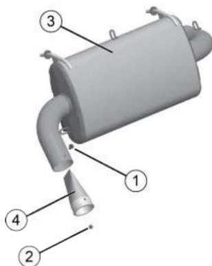
4. Inspeccione se há desgaste e danos na tela. Substitua uma tela desgastada ou danificada.
