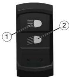
Se o interruptor do farol for LIGADO quando o interruptor de ignição estiver desligado, as luzes permanecerão acesas por aproximadamente 30 segundos.
