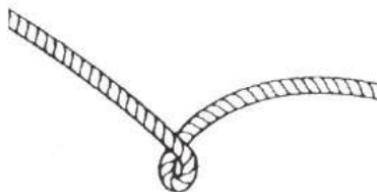
Um cabo do guincho dobrado que foi “endireitado” está exibido à direita. Mesmo que ele pareça utilizável, ele foi danificado permanente e seriamente. Ele não pode mais transmitir a carga que podia antes do dobramento. Interrompa imediatamente o uso do cabo do guincho nessa condição.
