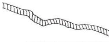
Cabos do guincho sintéticos devem ser inspecionados quanto a sinais de esgarçamento. Substitua o cabo se observar esgarçamento (mostrado a direita). Interrompa imediatamente o uso do cabo do guincho nessa condição. Substitua também o cabo do guincho se houver fibras fundidas ou derretidas. Uma área assim do cabo sintético estará rígida e terá a aparência lisa ou vitrificada. Interrompa imediatamente o uso do cabo do guincho nessa condição.
