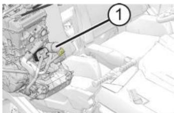
6. Usando um pano limpo e seco, limpe a superfície de vedação do filtro no cárter.
