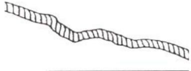
Cabos do guincho sintéticos devem ser inspecionados quanto a sinais de esgarçamento. Substitua o cabo se observar esgarçamento (mostrado abaixo). Interrompa imediatamente o uso do cabo do guincho nessa condição. Substitua também o cabo do guincho se houver fibras fundidas ou derretidas. Uma área assim do cabo sintético estará rígida e terá a aparência lisa ou vitrificada. Interrompa imediatamente o uso do cabo do guincho nessa condição.
