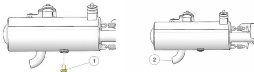
1. Remova o bocal de limpeza ① localizado na parte inferior do silenciador.
