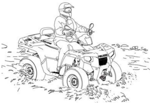
Seu VTT pode operar na água com uma profundidade máxima recomendada igual ao fundo dos descansos para os pés. Siga estes procedimentos ao trafegar na água:
