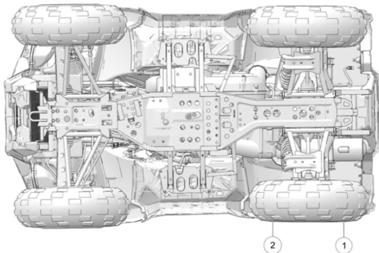
Use o seguinte procedimento para verificar o alinhamento da convergência/divergência do veículo. O alinhamento recomendado da convergência/divergência é de 6 a 12 mm (1/4 a 1/2 pol.).
