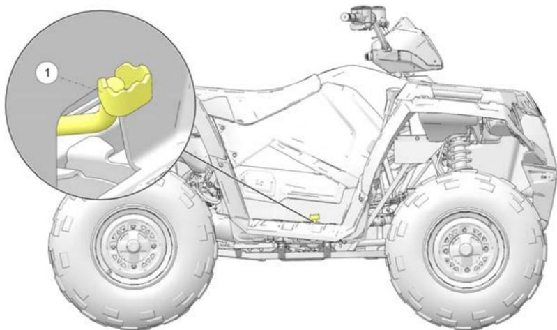
O sistema de freios auxiliar deve ser usado como uma reserva do sistema de freio principal. Caso o sistema principal falhe, use o pedal de freio auxiliar ①, que fica dentro do descanso para os pés do lado direito. Opere este freio com o pé direito. Se as rodas traseiras deslizarem enquanto o freio auxiliar é usado, *reduza* a pressão sobre o pedal de freio para frear as rodas traseiras sem patinar.
