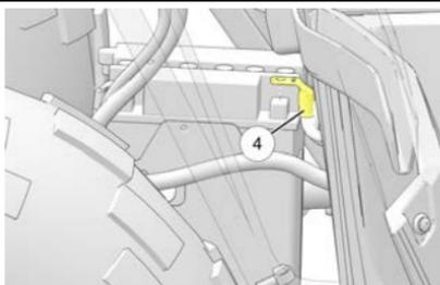
5. Conecte e aperte o cabo preto (negativo) ④. Torqueie conforme a especificação.
