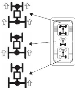
Pressione a parte inferior do interruptor para desbloquear o diferencial e permitir as rodas de tração traseiras operem de maneira independente. Esse modo de operação é adequado para dirigir em gramados ou sempre que não for necessária uma tração agressiva.
