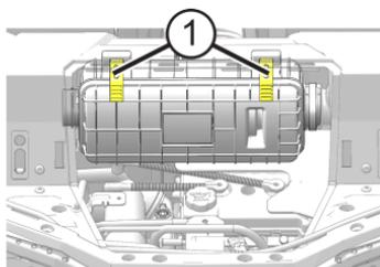
4. Inspeccione se há sujeira, detritos ou água no filtro de ar ② e na caixa do filtro de ar.
