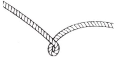
Um cabo do guincho dobrado que foi “endireitado” está exibido à direita. Mesmo que ele pareça utilizável, ele foi danificado permanente e seriamente. Ele não pode mais transmitir a carga que podia antes do dobramento. Interrompa imediatamente o uso do cabo do guincho nessa condição.
