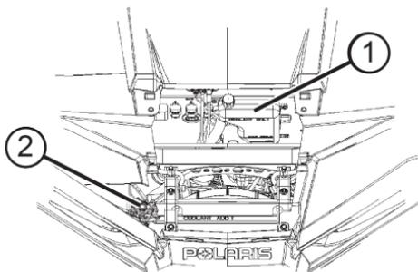
4. Remova a tampa ② e use um funil para adicionar líquido de arrefecimento conforme necessário para manter o nível entre as duas marcas.
