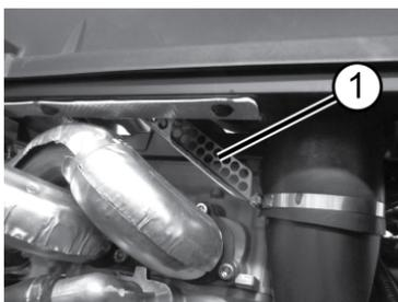
3. Remova os parafusos da tampa da embreagem e abra a tampa da embreagem. (Ela não precisa ser retirada do veículo). Remova todos os detritos presos dentro e ao redor do sistema PVT.
