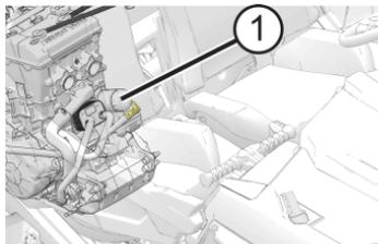
7. Usando um pano limpo e seco, limpe a superfície de vedação do filtro no cárter.
