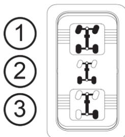
Quando o interruptor está em 2x4, o veículo está sempre com tração em duas rodas. Quando o interruptor está em AWD, o veículo tem tração em todas as rodas e o indicador 4x4 no painel de instrumentos ficará aceso.
