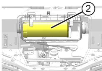
5. Para remover o filtro, deslize-o na direção do lado do passageiro do veículo.
