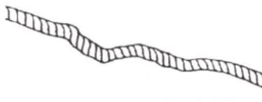
Cabos do guincho sintéticos devem ser inspecionados quanto a sinais de esgarçamento. Substitua o cabo se observar esgarçamento (mostrado abaixo). Interrompa imediatamente o uso do cabo do guincho nessa condição. Substitua também o cabo do guincho se houver fibras fundidas ou derretidas. Uma área assim do cabo sintético estará rígida e terá a aparência lisa ou vitrificada. Interrompa imediatamente o uso do cabo do guincho nessa condição.
