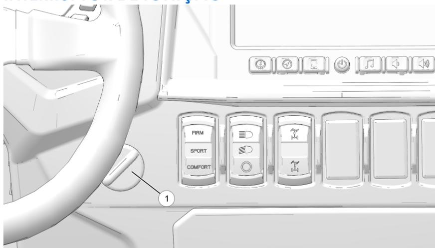
O interruptor de ignição ① tem quatro posições, sendo acionado por chave. Use o interruptor de ignição para ligar o motor. Consulte a página 76 para informar-se sobre os procedimentos de partida.
