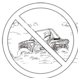
Freios úmidos podem ter capacidade de frenagem reduzida. Teste os freios após sair da água. Acione-os levemente e várias vezes trafegando lentamente ao mesmo tempo. O atrito ajudará a secar as pastilhas.
